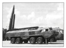
Transport-/Startfahrzeug 24 Tonnen (8  $\times$  8) 9P71 mit Rakete in Startposition.
