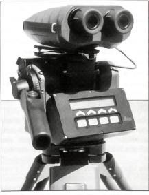
Kampfwertsteigerung für Ihre Artillerie: Vector IV auf einem digitalen Goniometer Leica SG12. Diese Kombination bietet 1-Strich-Winkelmessgenauigkeit und Programme zur Orientierung, Standort- und Zielbestimmung. Neben Vector kann auch ein Wärmebildgerät montiert werden, um die Beobachtung rund um die Uhr sicherzustellen.
