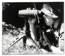
Mörser Beobachter mit Sprechfunkgerät übermittelt die Lage des Ziels (Entfernung, Azimut, Neigungswinkel) an die Batteriefeuerleitstelle. Genaues Anzielen ist wichtig bei grossen Entfernungen, darum ist Vector IV auf einem taktischen Kleinstativ befestigt.
