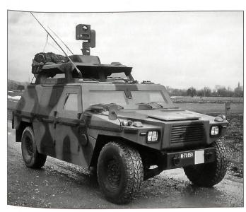
Leicht gepanzertes Fahrzeug für die Schiesskommandanten der Panzertruppen. Auf dem Dach das Navigations- und Vermessungsgerät.
