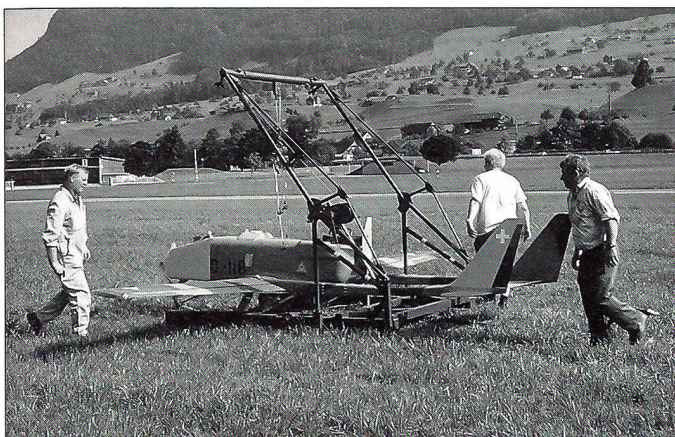
Mit einem speziellen Gestell kann der Ranger nach der Landung abtransportiert werden.
