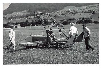
Mit einem speziellen Gestell kann der Ranger nach der Landung abtransportiert werden.
