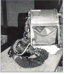
Das Kreislaufgerät 84 (KG 84) bietet Schutz und den nötigen Sauerstoff für vier Stunden. Das Gewicht von 14.5 kg bedingt für die Träger zunächst einen Fitnesstest.
