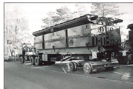
Ein einzelnes verladenes 10 Meter langes und 11 Tonnen schweres Modul.
