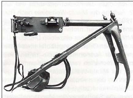
Maxim-Maschinengewehr 1894 «Gotthard-maschinengewehr» auf Refflafette, Gewicht ungeladen: 21,2 kg.
