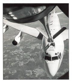
Auf einem Fieldtrip von Andrews Air Force Base nach New Orleans flogen wir an Bord eines Tankers KC-135R der US Air Force mit. Dabei konnten wir aus der Kanzel des «Boom-Operators» aus nächster Nähe ein Betankungsmanöver mit einer EC-135H verfolgen.
