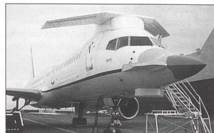
Boeing-eigenes Testflugzeug Boeing 757 mit der Elektronikausrüstung der F-22A Raptor.
