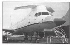
Boeing-eigenes Testflugzeug Boeing 757 mit der Elektronikausrüstung der F-22A Raptor.
