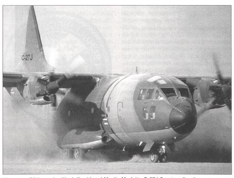
Ein erstes Bild von der Alenia/Lockheed Martin Marietta C-27J Spartan. Der Prototyp erinnert an die G.222 und den mittelschweren Transporter C-130J Hercules. Die C-27J Spartan weist einige auffallende Gemeinsamkeiten mit der C-130J auf. Das Triebwerk, die Sechsblattpropeller und die Avionik sind fast identisch.
