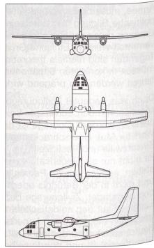
Die Abmessungen der Alenia/Lockheed Martin Marietta C-27J Spartan betragen: Spannweite 28,70 Meter, Länge 22,70 Meter, Höhe 9,80 Meter, Flügelfläche 82,00 Quadrat-
