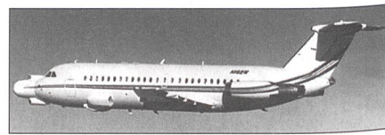
Stark modifizierte BAC One Eleven von Northrop Grumman als Elektronik-Test-Flugzeug für die JSF von Lockheed Martin.
