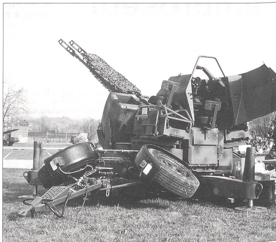
35-mm-Flab-Kanone, vollautomatisches Zwillinggeschütz mit 4000 m Wirkungsdistanz und total 7700 kg Gewicht.
