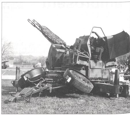
35-mm-Flab-Kanone, vollautomatisches Zwillingsgeschütz mit 4000 m Wirkungsdistanz und total 7700 kg Gewicht.
