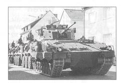
Mann-Turm mit einer 30-mm-Maschinenkanone von Mauser und einem koaxialen 7,62-mm-Maschinengewehr. Neben der drei Mann Besatzung – Fahrer, Kommandant und Bordschütze – wird die Schützenpanzerversion acht Soldaten Platz bieten. Der «Ulan» ist ein Teil einer leichten Panzerfamilie, bei der es u.a. Versionen von Aufklärungs-, Sanitäts-, Fliegerabwehr-, Pionierund Mörserpanzern gibt.
