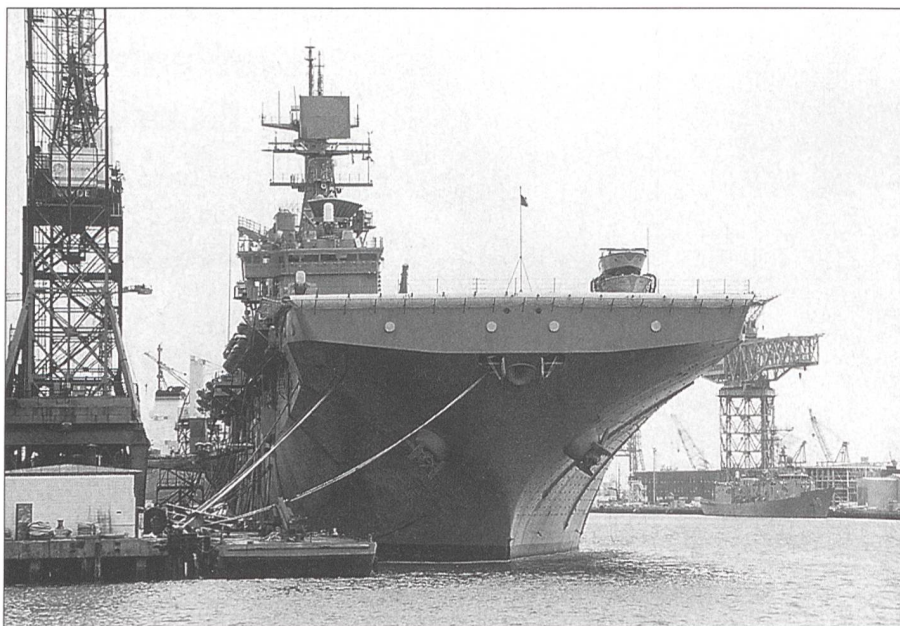
Das Bild zeigt die «USS Bataan» (LHD-5), die fünfte Einheit der «Wasp»-Klasse. Das von Litton Ingalls in Mississippi gebaute Schiff verdrängt 40 500 Tonnen, ist 254 m lang, rund 35 km/h schnell, kann gegen 40 Helikopter und Kampfflugzeuge eine Besatzung von 1200 Personen und eine Marineinfanterie-Kampfgruppe von etwa 2000 Personen aufnehmen.
