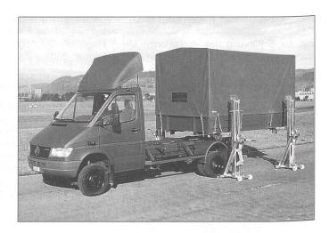
Aufbauwechsel mittels Hubstützen
