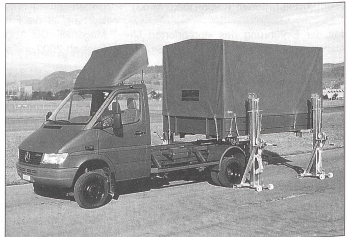
Aufbauwechsel mittels Hubstützen
