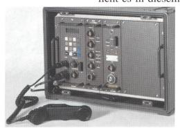
2 Mbps-Schnittstellen gleichzeitig über eine 8 Mbps-Richtstrahlverbindung verschlüsselt zu übertragen. Diese 4 universellen Schnittstellen unterstützen die ITU-T Empfehlungen G.703 und V.35 sowie die EU-ROCOM-A-Spezifikationen. Für den R-905-Einsatz ist neu zusätzlich ein digitaler Telefon-
