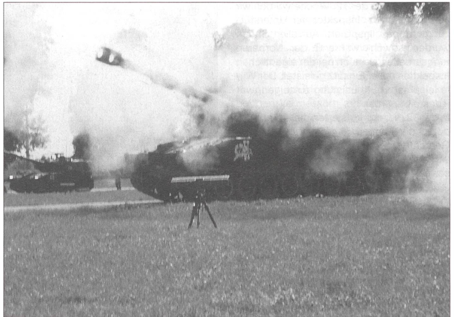
Eine M-109 Panzerhaubitze, aufgenommen zum Zeitpunkt des Abschusses. Es handelt sich hierbei um das Fahrzeug «Sexi» der II. Bttr. Im Vordergrund das Prisma, welches zum Einrichten und Festlegen gebraucht wird.
