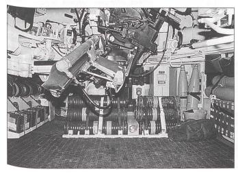
In das Innere der Panzerhaubitze M 109 geguckt. Links die halbautomatische Ladevorrichtung.
