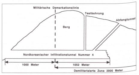
Die Skizze illustriert im Querschnitt die Lage des Infiltrationstunnels «4».
