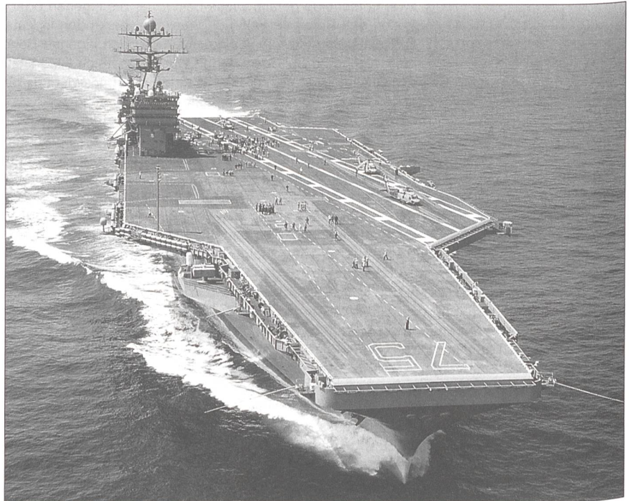
Der neueste Flugzeugträger der US Navy, die «USS Harry S. Truman», auf einer Versuchsfahrt vor der Küste von Virginia. Deutlich kommen die riesigen Ausmasse des über 330 m langen und 77 m breiten Flugdecks zum Ausdruck. Klar zu erkennen sind auch die zwei Katapultbahnen auf dem Vorderdeck und die schräg zur Schiffsachse verlaufende Landebahn. Hier sind zwei weitere Katapulte eingebaut.
