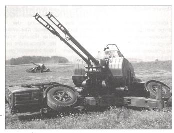
Mittlere Fliegerabwehr-Feuereinheit mit Feuerleitgerät 75/90 und zwei 35-mm-Fliegerabwehrkanonen 63/90 (Foto: AFD)
