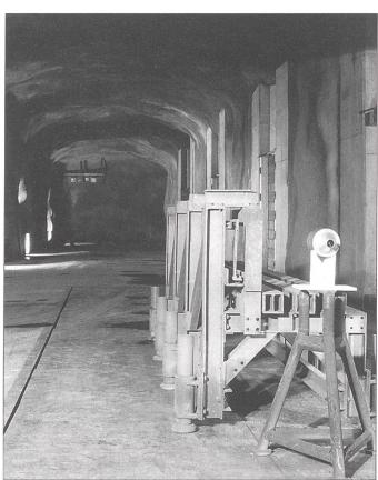
Sprengkammer mit aufgebauten Sprengdispositiv.
