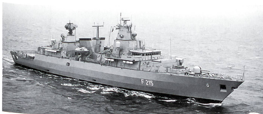
Das Leitschiff der Fregatte Typ 123, die «Brandenburg». Auf dem Vorschiff sind der 76-mm-Geschützturm und ein RAM-See-Luft-Raketenwerfer installiert. Unmittelbar hinter dem RAM-Werfer und der Kommandobrücke sind die Startschächte für die See-Luft-Lenk Waffen SEA SPARROW erkennbar. Auffallend ist die hochgezogene Rumpfwand der Fregatte, die auch auf eine gute Hochseetauglichkeit hinweist.
