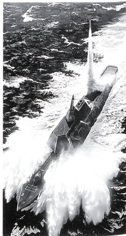
Das Bild zeigt einen Entwurf für ein «Arsenal»-Schiff der Firma Lockheed-Martin. Vor der Brücke mit den besonderen Konturen eines geringe Radarschatten erzeugenden Schiffes ist die besonders grosse Zahl von Startkanistern für die Marschflugkörper ersichtlich.
