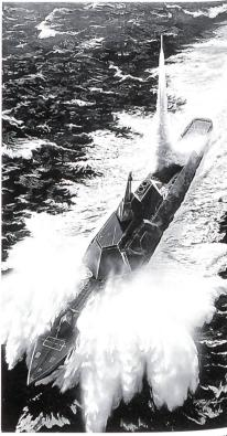
Das Bild zeigt einen Entwurf für ein «Arsenal»-Schiff der Firma Lockheed-Martin. Vor der Brücke mit den besonderen Konturen eines geringe Radarschatten erzeugenden Schiffes ist die besonders grosse Zahl von Startkanistern für die Marschflugkörper ersicht-
