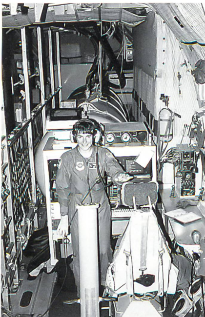
Dropsonden-Operator Airman Tina Young an ihrem Arbeitsplatz. Im Hintergrund ist der 1800-Gallonen-Zusatztank erkennbar, im Vordergrund das Rohr des Auswurfmechanismus.
