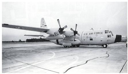
WC-130 H des 53rd WRS auf der Flightline auf der Keesler AFB. Die Wetterversion «W» ist erkennbar durch das dunkle Band mit der Aufschrift «Weather» auf dem Seitenleitwerk.
