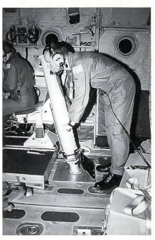
Dropsonden-Operator TSgt Scott Persinger beim Ausstoss einer Dropsonde.
