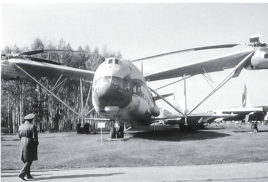
Mi-12, ein schwerer Transporthelikopter, Nutzlast: 40 Tonnen.
