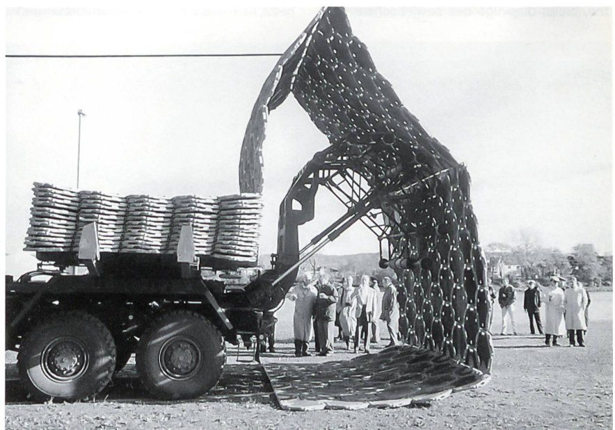
Faltstrassengerät zur Überwindung von extrem weichen Böden. Z B für die Zu-/Wegfahrt (50 m) von Kampfpanzern MLC 60 zu Pionierbrücken. Das Gerät ist eine deutsch-französische Entwicklung.
