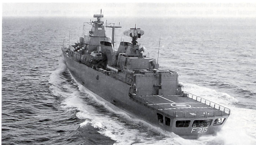
Eine Heckansicht der «Brandenburg». Gut erkennbar sind das Flugdeck und die beiden Hangars für die U-Bootabwehr-Helikopter SEA LYNX Mk 88. Der gespaltene Schornstein reduziert die Ortungsgefahr, weil die heissen Abgase der Gasturbinen verteilt werden.
