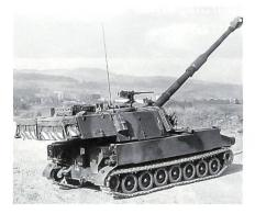
Schon bald nach der Einführung wurden die Geschütze mit einem längeren Rohr (L39, entspricht 39mal dem Kaliber von 15,5 oder 6 Metern) ausgerüstet. Damit konnte die Reichweite auf maximal 18 km (Stahlgranaten) gesteigert werden. Verschiedene weitere Modifikationen folgten im Laufe der Zeit, die die Einsatzbereitschaft und Feuerkraft laufend steigerten.
