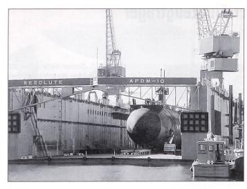
In der Naval Station Norfolk werden auch Schiffe und Boote der Atlantikflotte überholt. Hier befindet sich das Atom-U-Boot USS Scranton (SSN-756) auf dem Schwimmdock «Resolute» (AFDM-10).
