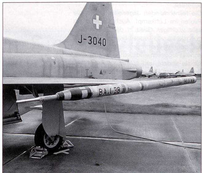
Dieser Pod sendet die Flugparameter an die Auswertestelle.
