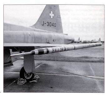
Dieser Pod sendet die Flugparameter an die Auswertestelle.
