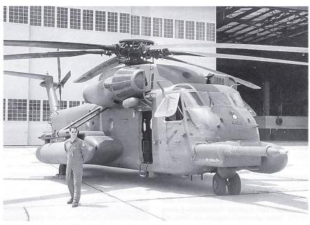
Ein Helikopter des Typs MH-53J «Pave Low III» der US Air Force auf dem Luftwaffenstützpunkt von Kirtland in New Mexico. Diese Maschinen sind zur Luftbetankung ausgerüstet und in der Lage, bei jedem Wetter und nachts Special Forces im Tiefflug und über grössere Distanzen zu infiltrieren bzw. zu exfiltrieren.
