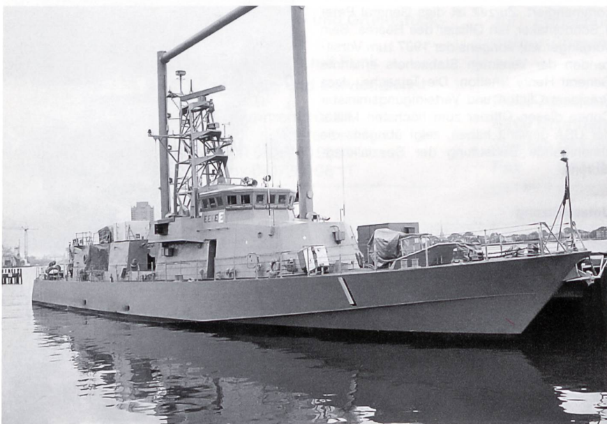
Die Navy setzt Special Forces in der Regel aus U-Booten (auch getaucht) ab. Sie verfügt aber auch über mit zwei 25-mm-Gatling-Kanonen und zwei Maschinengewehren bewaffnete Kampfboote der «Cyclone»-Klasse, die speziell zum Absetzen von Special Forces (SEALS) geeignet sind. Das Bild zeigt die «USS Cyclone» in Norfolk. Das Boot verfügt über eine spezielle Heckrampe zum Wassern eines ZODIAC-Schlauchbootes mit 8 SEALS.
