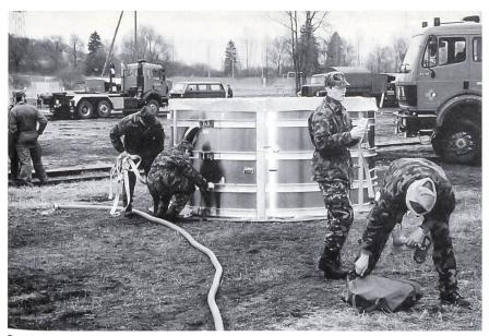
Der Truppe stehen verschiedene Becken zur Verfügung, die entweder kontaminierte oder bereits gereinigte Flüssigkeiten aufnehmen können.
