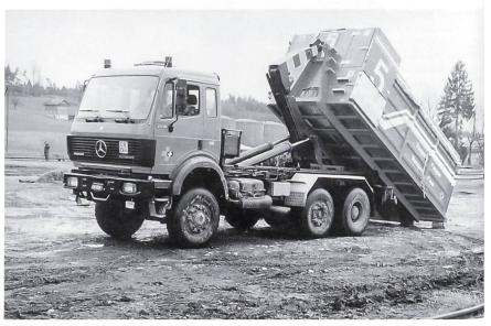
Beim Katastrophenhilferegiment ist das Material in Containern versorgt und kann mittels Trägerfahrzeugen auf die Schadenplätze gefahren werden.
