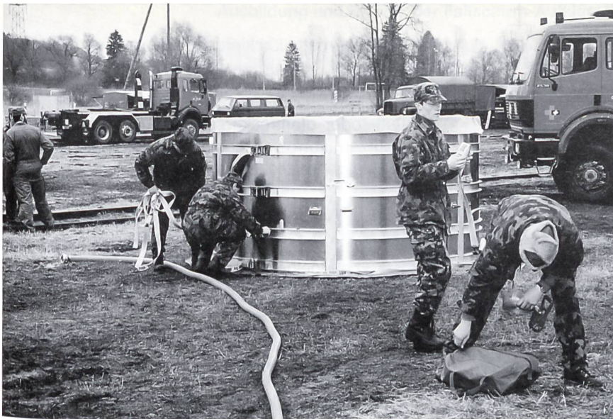
Der Truppe stehen verschiedene Becken zur Verfügung, die entweder kontaminierte oder bereits gereinigte Flüssigkeiten aufnehmen können.
