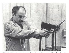
Simulatoren ersetzen heute teilweise die Schiessübungen mit scharfem Schuss. Von der Pistole (Bild) bis zur Lenkwaffe lässt sich diese Technik überall anwenden. Anstelle von kostspieliger und lärmträchtiger Munition trifft ein Laserstrahl auf das Scheibenbild und meldet die Flugbahn und die Lage des Aufschlages.
