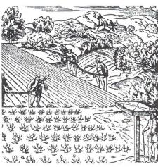
Landmesser mit Messketten, Messstäben und einer Winkelscheibe bei der Arbeit. Die Stäbe dienen als Zählstäbe bei mehrmaligem Abtragen der Messkettenlänge und als Markierung der Anfangs- bzw. Endpunkte, womit ein präzises Anvisieren mittels der Winkelscheibe möglich ist.
