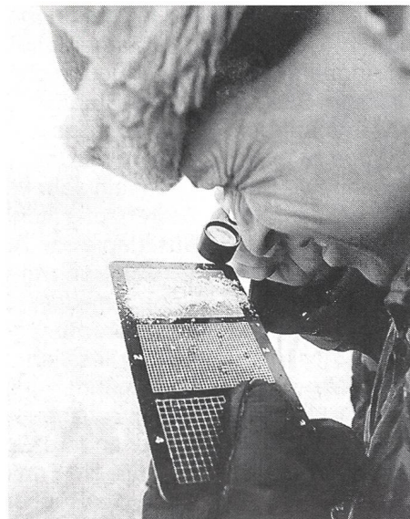
Schneedeckenuntersuchung: Bestimmen von Kornform und Korngrösse mit Raster und Lupe.
