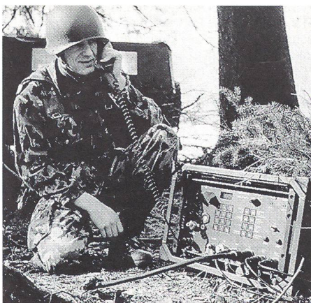
Ab 1999 im Einsatz: die flexible, transportable Richtstrahlstation R-916 von Alcatel Schweiz AG.
