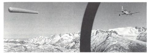
Ein Pilatus PC-9 mit ausgefahrenem Schleppsack. Der orange Schleppsack dient als Ziel für die Fliegerabwehrkanonen und wird in einer Distanz von 900 Metern hinter dem Flugzeug hingezogen.
