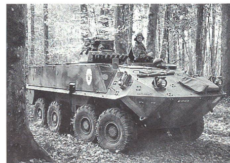
Das neue Transportmittel – der Schützenpanzer 93. Am Turm vorne sind die Nebelwurfbecher zu erkennen.
