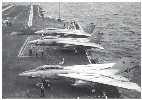
Zu den Kampfflugzeugen an Bord der USS John C. Stennis gehören auch diese F-14 A-Tomcat-Jagdbomber der Fighter Squadrons 14 und 41, die hier auf dem Vorschiff der USS John C. Stennis auf den Katapultstart warten. Am oberen Bildrand sind die beiden Katapulte Nr 1 und 2 erkennbar.
