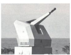
Im Marine-Nahbereich-Abwehrgeschütz «Millennium» ist die 35/1000-Revolverkanone von OC integriert.
