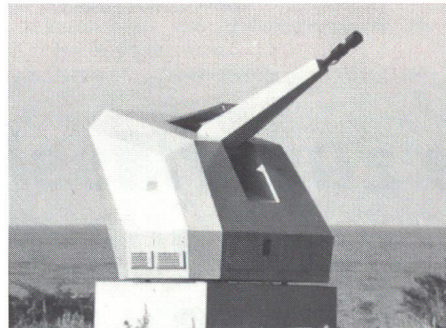
Im Marine-Nahbereich-Abwehrgeschütz «Millennium» ist die 35/1000-Revolverkanone von OC integriert.
