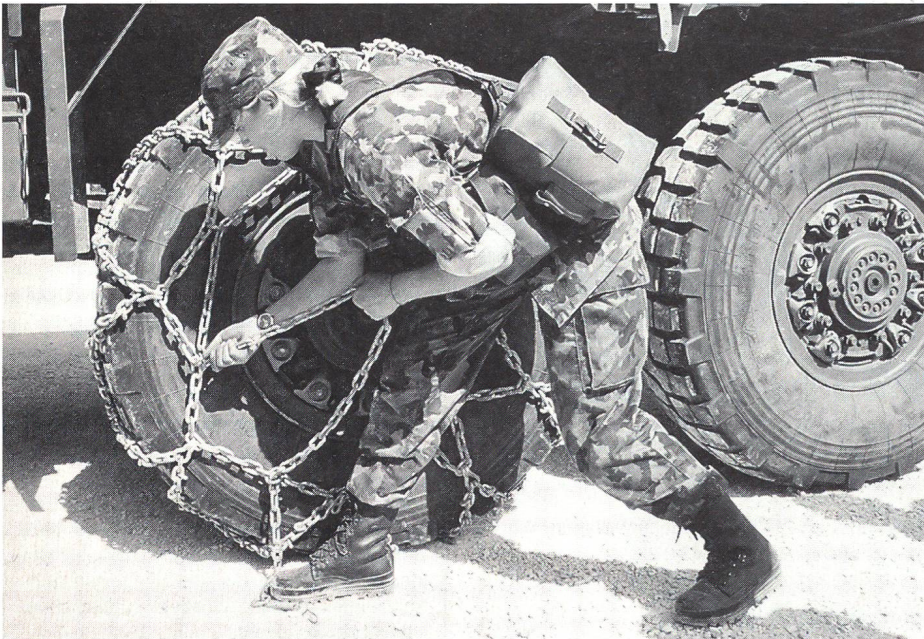
Hau ruck! Im Winter wird man froh sein, das Montieren von Schneeketten geübt zu haben, im Schweisse seines Gesichtes in der Sommer-RS.
