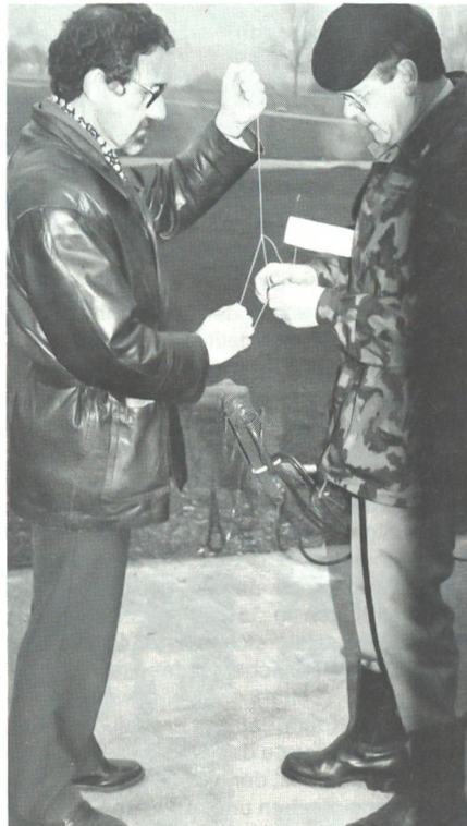
Herr Bossi der Firma Meteolabor zeigt zusammen mit Adj Uof Zangger die Befestigung der Sonde an der Ballonschnur.
