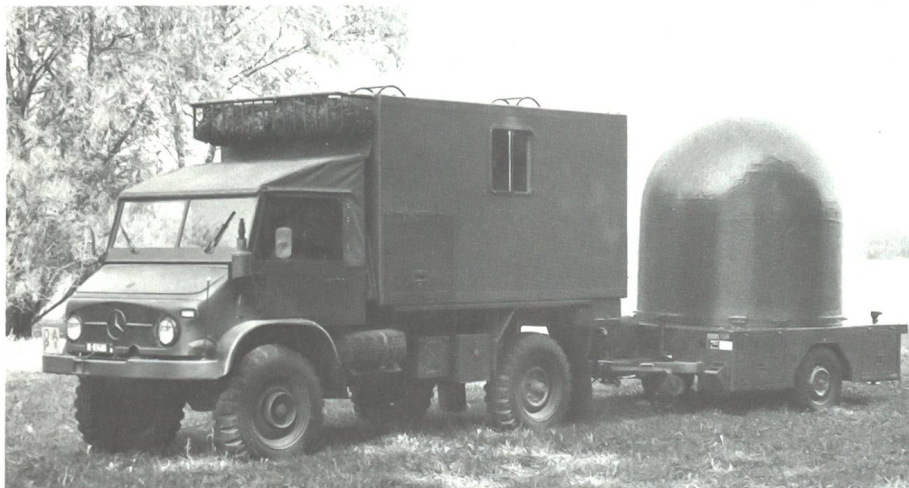
Das Zugfahrzeug Unimog S mit Auswertekabine und dem Radaranhänger (Telemetrieinheit). Mit der Telemetrieinheit werden die Temperatursignale empfangen und die Abstriftung der Ballonsonde gemessen.
