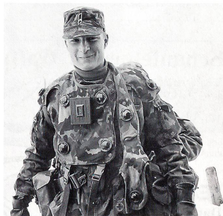
Aspirant Markus Christen, Elektromonteur aus Andermatt, mit montiertem Schiess-Simulator SIM für Sturmgewehr 90. Die «Runden Augen» sind Sensoren. Das schwarze Kästchen ist der Empfänger.
