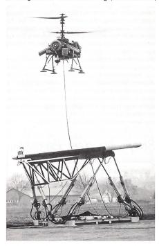
programmgesteuerte Streckenflüge nach vorgegebenen Wegpunkten Änderungen der vorprogrammierten Routen während des Fluges, direkte Bildübermittlung bzw Bildübertragung usw vorzunehmen. Kurz: Die neuartige Rotorplattform soll als Aufklärungsdrohne von Schiffen und Booten aus manövrierbar sein. – Unser Bild: Start von «Seamos» von einer automatisch bewegten Plattform (die die Schiffsbewegungen simuliert) zum Einsatz.
