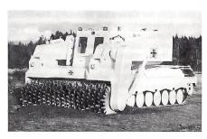
und Swedisch Demining sowie von Tonstad Maskinfabrikk AS aus Norwegen. Das Fahrzeug basiert auf einem Leopard-1-Fahrgestell, an das ein Roller integriert wurde. Während der Vorführung wurden im ersten Durchgang 10 von 12 Schützenminen unschädlich gemacht. Nach diesem Erfolg in dem frühen Stadium der Entwicklung sind die beteiligten Firmen überzeugt, die von den UN geforderte Räumsicherheit von 99,6% zu erreichen.
