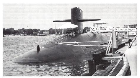
Das getaucht über 18 700 Tonnen verdrängende und 170 Meter lange Raketen-U-Boot *«USS Maine»* liegt vertäut am Pier in Kittery, Maine. Es ist wesentlich grösser als ein normaler Kreuzer. Im Turm sind die diversen ausfahrbaren Instrumente (Sehrohr, Radar usw) untergebracht. Zudem sind deutlich die Höhen- resp Tiefenruder erkennbar.
