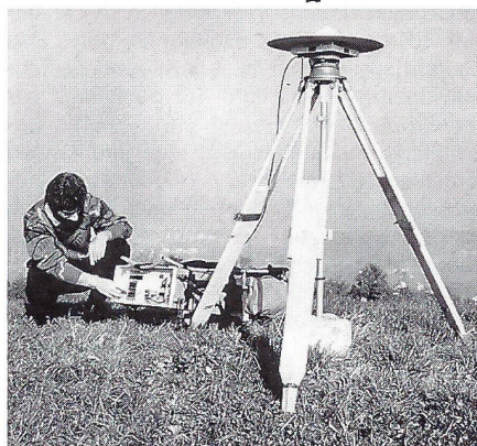
GPS-Satellitenempfänger statt Holzlatte: Die neue Landesvermessung hat das Gebiet der Schweiz jetzt auf den Zentimeter genau erfasst.
