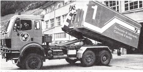
Ausbildung Auf- und Abladen eines Wechselladerbehälters (WELAB)
