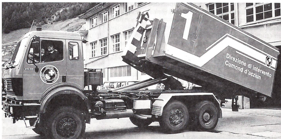
Ausbildung Auf- und Abladen eines Wechselladerbehälters (WELAB)
