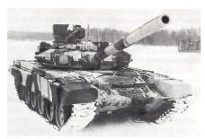
Während die Basisversion des T-72 von 1972 noch einen relativ *«aufgeräumten»* Turm aufwies, fallen beim T-90 die zahlreichen und voluminösen Aufbauten am Turm auf. Erkennbar sind die beiden Laser-Warnsensoren oberhalb der Blende und der rechte IR-Störsender des aktiven Schutzsystems SHTORA.
