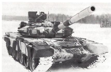
Während die Basisversion des T-72 von 1972 noch einen relativ «aufgeräumten» Turm aufwies, fallen beim T-90 die zahlreichen und voluminösen Aufbauten am Turm auf. Erkennbar sind die beiden Laser-Warnsensoren oberhalb der Blende und der rechte IR-Störsender des aktiven Schutzsystems SHTORA.
